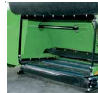
Doppio scarico destra/sinistra con tappeto regolabile in altezza. Left and right centrally positioned unloading doors with height-adjustable discharging chutes.
