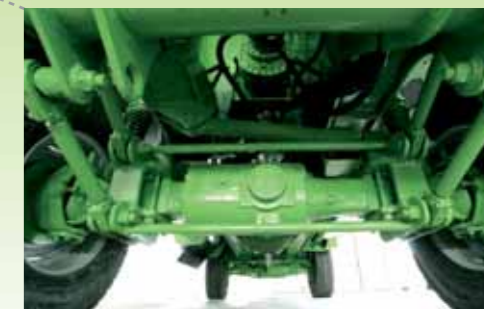
Sospensioni idropneumatiche anteriori a bracci indipendenti Hydropneumatic front suspension with independent arms Suspensiones hidroneumáticas anteriores con brazos independientes
